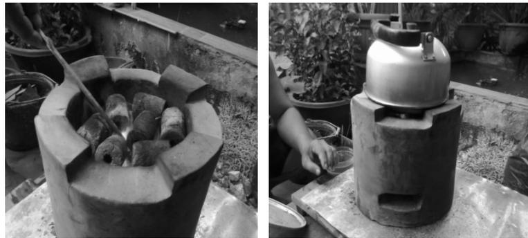
Gambar 3. Pengujian laju kecepatan memasak
